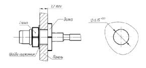
Схема монтажа и разметка посадочного места для крепления вилок
